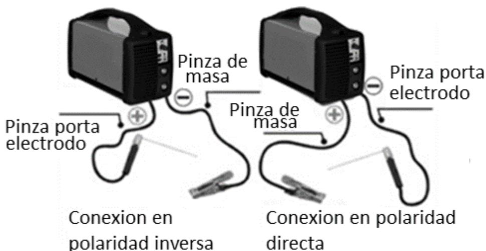
1. Conectar la pinza de masa a la máquina en la salida negativa (si va a utilizar Polaridad INVERSA) con el sistema de conexión rápida.
